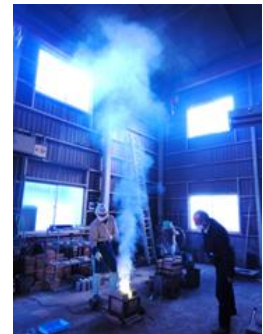
溶融した銅に亜鉛を加えると、亜鉛はたちまち白煙となって飛散する
